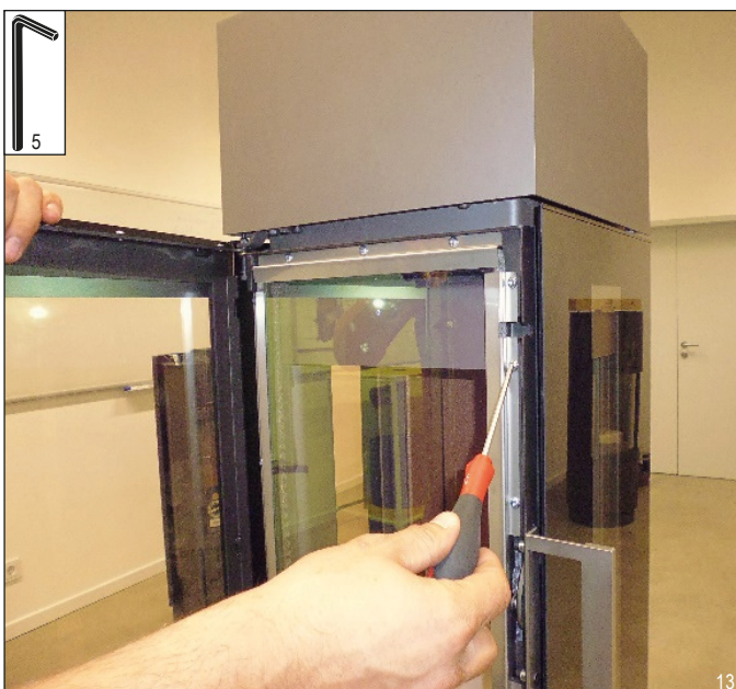
5. Scheibenwechsel seitlich (Einbau in umgekehrter Reihenfolge)
