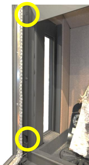
2. ヒンジ部の上下2か所の六角穴ボルト（4ミリ）をゆるめます（外しません） ※中央のボルトをゆるめる必要はありません
