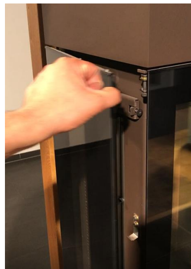
4. 左側のガラス面が開きます。開かない場合は、2. のボルトをもう少しゆるめます
