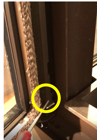
2. ヒンジ部の上下2か所の六角穴ボルト（4ミリ）をゆるめます（外しません） ※中央のボルトをゆるめる必要はありません
