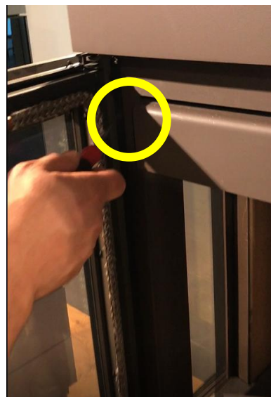
2. ヒンジ部の上下2か所の六角穴ボルト（4ミリ）をゆるめます（外しません） ※中央のボルトをゆるめる必要はありません
