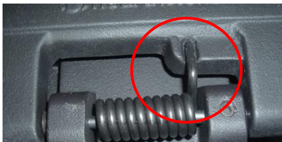
9. 長いほうの端がドアのこの部分に収まるようにスプリングを取り付けます。
