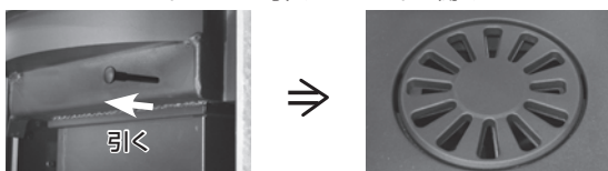
【写真2】 グレートレバーを引くとグレートが開く
