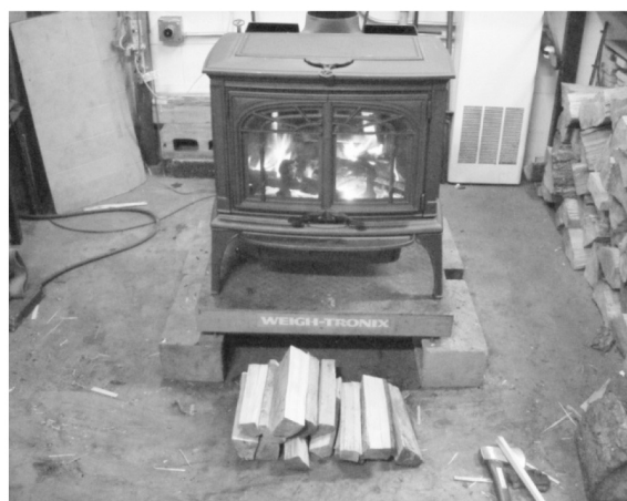
④ 焚き付けに火が入るまで5分程待ち、付属のポーカークで火のついた焚き付けを平らにならしめます。その上に中サイズの薪を重ねます。
