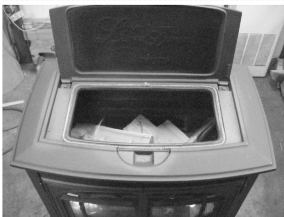
⑤ 火室の2/3くらいが埋まるように中サイズの薪を入れます。いきなり大サイズを使わないのは、その方が長時間燃焼に大切な熾火(おきび)をより早く作ることができるからです。
