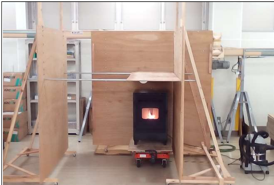
検証状態の写真（離隔距離②）
