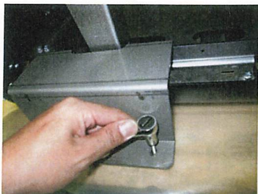
4) 対角 10mmのソケットレンチで本体固定ブラケットのネジ 2 本を取り外します。
