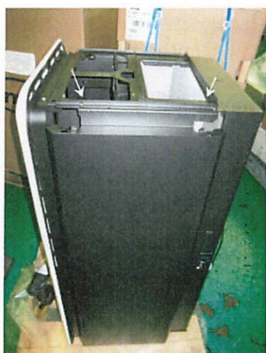
8) 付属のネジを 2 か所、+ドライバーで締めつけて、サイドパネルを図の様に固定します。
